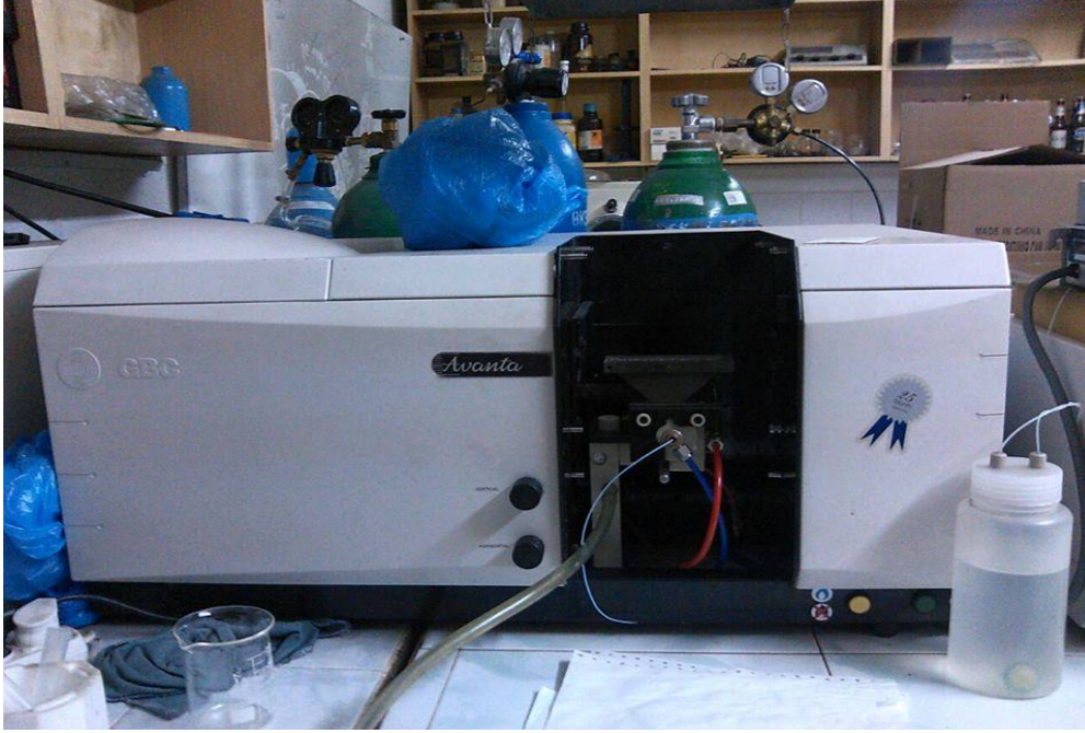
Şekil 3.1. GBC Marka Avanta PM Model Atomik Absorpsiyon Spektrometresi
