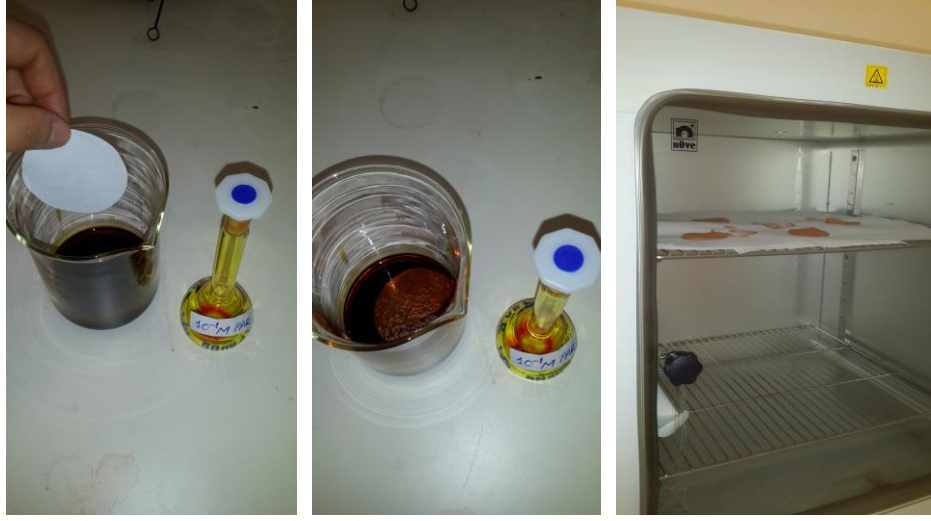
Şekil 3.3. PAR çözeltisinin süzgeç kağıdına emdirilmesi ve kurutulması
