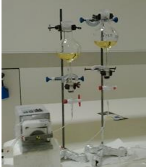
Şekil 3.7. Zenginleştirme işlemlerinin gerçekleştirildiği düzenek
