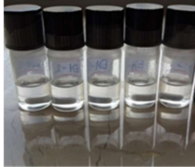
Şekil 3.11. Glove-Box içerisinde farklı oranlarda B-GC ve DEC karıştırılarak hazırlanan 1M LiPF 6 elektrolit çözeltileri: B-GC/DEC oranları soldan sağa 0/100, 20/80, 40/60, 50/50, 60/40.
