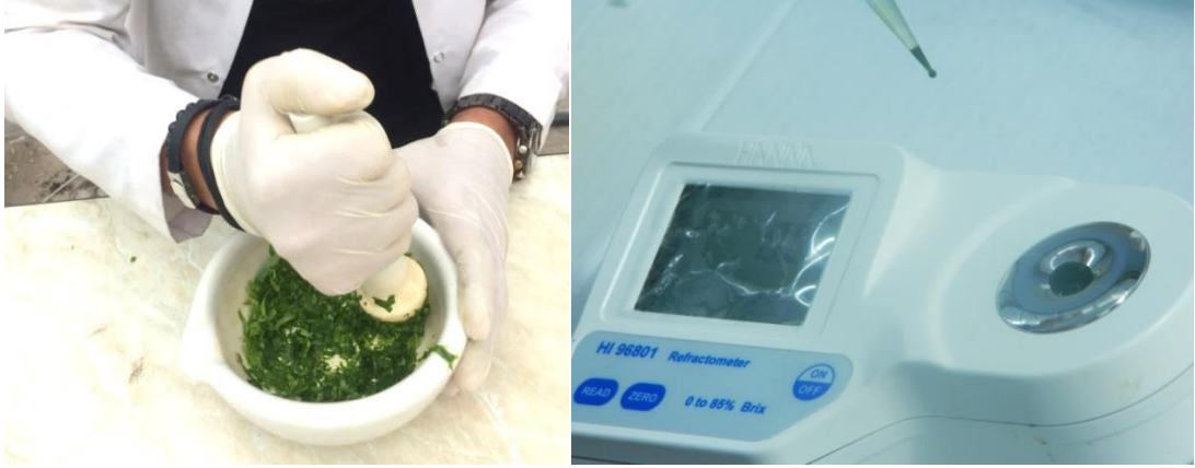
Şekil 24. Fide yapraklarının ezilmesi ve yaprak suyunun dijital refraktometre ile ölçülmesi
