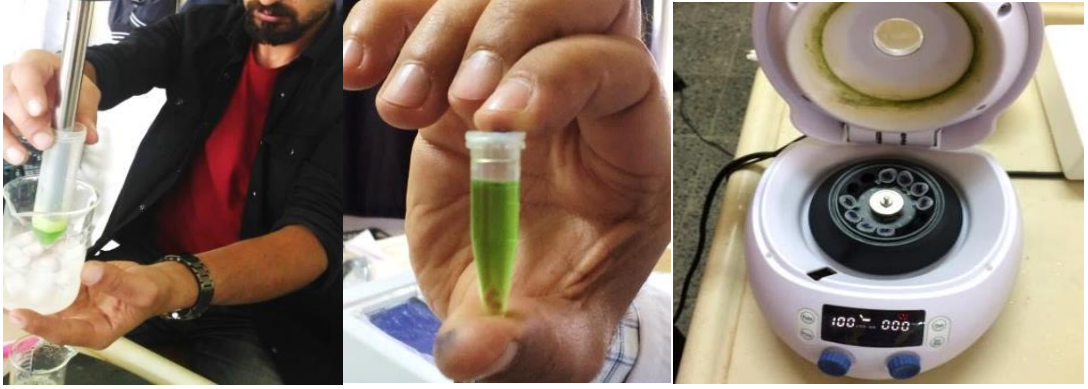
Şekil 26. Yaprak örneklerinin asetonda parçalanması ve santrifüj edilmesi
