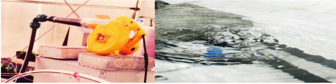
Şekil 7. Hidroponik sistemde O 2 sağlamak amacıyla kullanılan hava kompresörü
