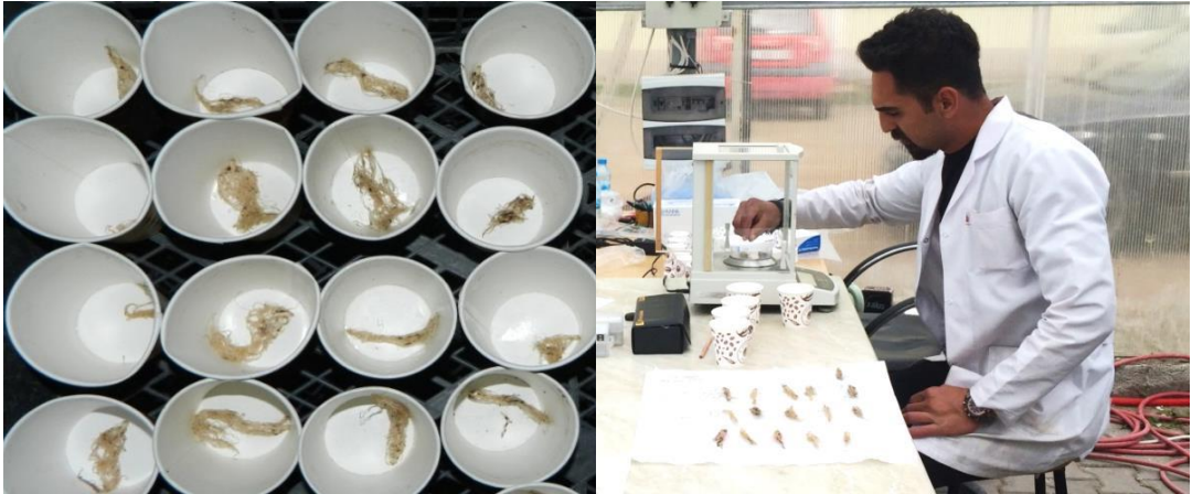
Şekil 23. Etüvde kurutulan kök örneklerinin tartılması
