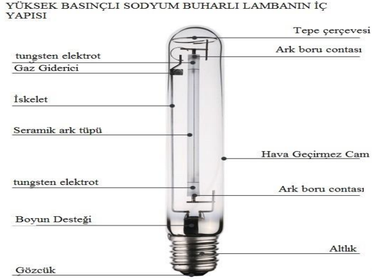
Şekil 1.1.3.1. Yüksek Basıncılı Sodyum Buharlı Deşarj Lamba Yapısı (Anonim, 2017h)
