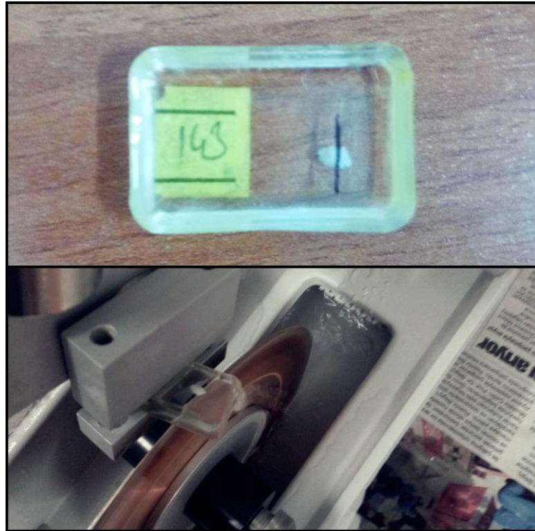
Şekil 3. 6. Lapillusların kesim düzlemi ve kesit alma tekniği.
