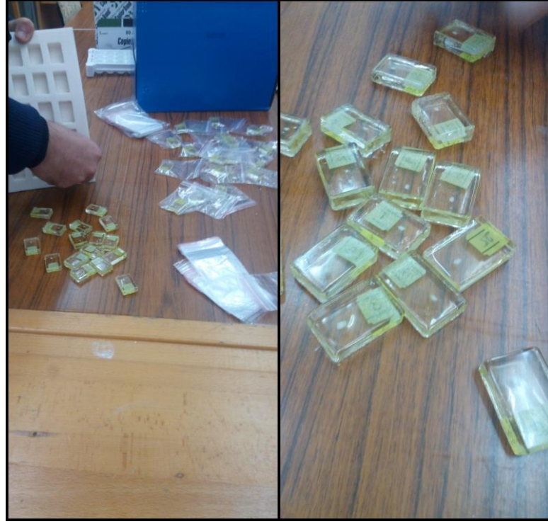
Şekil 3. 5. Lapillus örneklerinin silikon kalıplardan çıkartılması.
