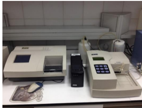
Şekil 3.6. Analizde kullanılan Rayto® marka mikro plaka okuyucusu ve yıkayıcısı
